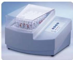
一些化学指标例如 COD/TOC/ 总磷 / 总氮等需要使用消解器对水样进行消解处理后, 方可测量, 全新推出的 ET99125N 消解反应器可满足用户多种需求。24 孔设计, 可同时消解多个水样, 设有 100, 120, 150°C 三档温度选择; 30, 60, 120min 和持续加热时间选择。
