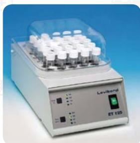
某些化学指标例如 COD/TOC/ 总磷 / 总氮等需要使用消解器对水样进行消解处理后, 方可测量, ET99125 消解反应器可满足用户多种需求。25 孔设计, 可同时消解多个水样, 设有 70, 100, 120, 150°C 四档温度选择; 30, 60, 120min 和持续加热时间选择。
